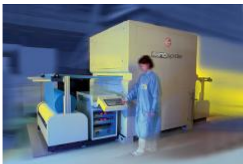
Zařízení nanospider je světově unikátním systémem na průmyslovou výrobu nanovláken a nanotextilií.
